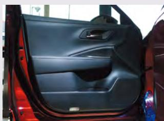
ドア内張りの外し方は外周のクリップやドアハンドル付近の隠しネジなど、車種によって異なる。傷つけないように養生を施しながら作業を行う。
