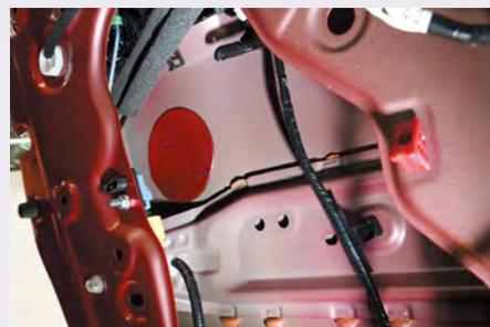
制振材は施工箇所や目的に合わせて3種類が用意される。 OUTER パネルに貼るタイプはスピーカーとの共振を抑えるための部材。
