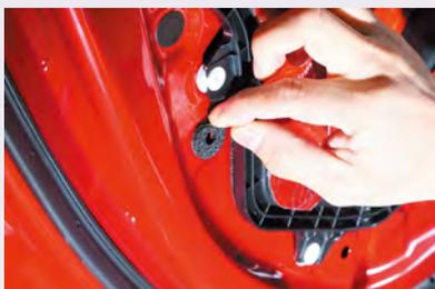
防音材はインナーパネルとドアトリムの隙間を埋めることで、振動音や軋み音を防ぐための部材。クリップダンパーなどを貼り付ければ万全。
