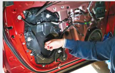
最近のモデルではサービスホールカバーが樹脂製に変更されていることが多く、この振動もスピーカー性能をスポイルする。そのため軽く叩きながら施工部分を探っていく。
