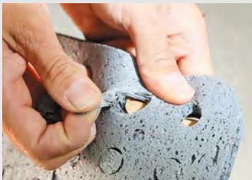
施工が必要な箇所を把握したところで、次にスピーカー裏の OUTER パネルに吸音材を貼り付ける。装着するスピーカーサイズに合わせてコントロールチップを抜き取る。
