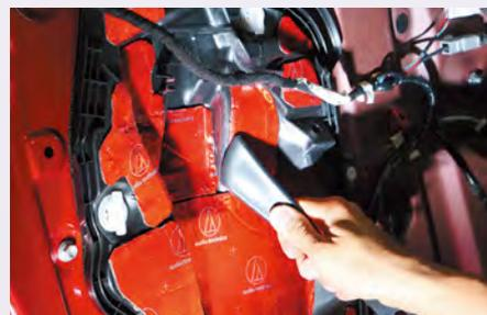
先ほどの確認でサービスホールカバーなどインナーパネルも施工が必要と判断。インナーパネル用は大きめのシートのため自由にカットして施工できる。
