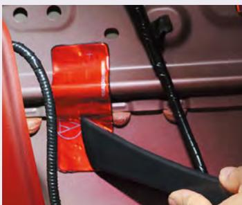
細長いポイントチューニング用はサイドピームなどの構造物と OUTER パネルを繋ぐことで共振を防ぐ。付属のヘラで密着率を高めるのも作業のポイント。
