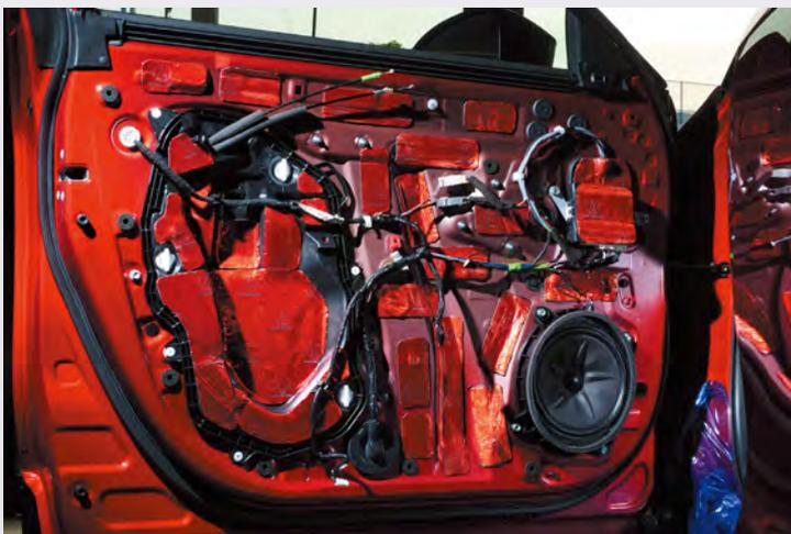
プロの手によるドアチューニングではご覧のように多くの部分に制振材が張り込まれる。余分な振動やスピーカーからの反響を抑えることで、純正スピーカーでも音のクレが格段に向上しているのは大きなメリットだ。
