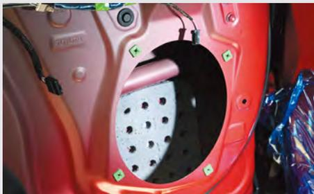
スピーカーが発する不要な音の反射を抑えるのが吸音材の機能。ドア内部に貼り付けるため、ハイグレードモデルでは排水性の高い素材を使用しているのも特徴。
